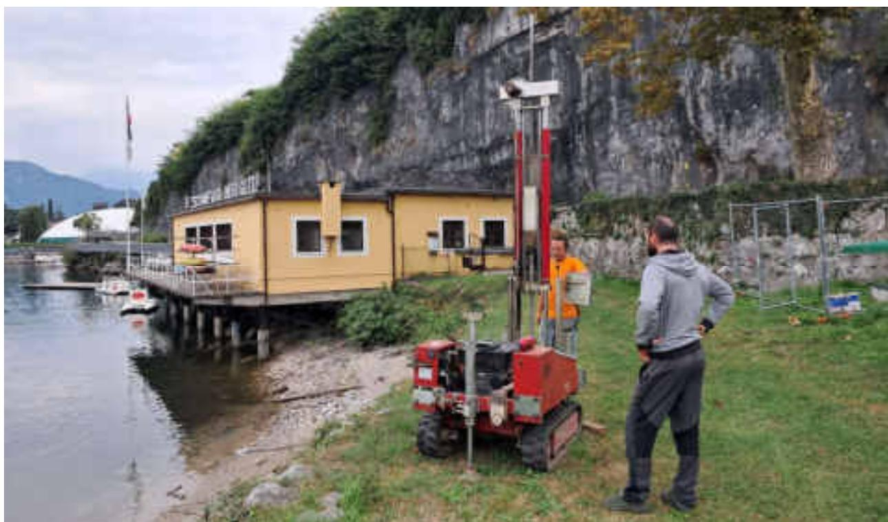
Foto n. 2 – Prova penetrometrica SCPT n. 2
