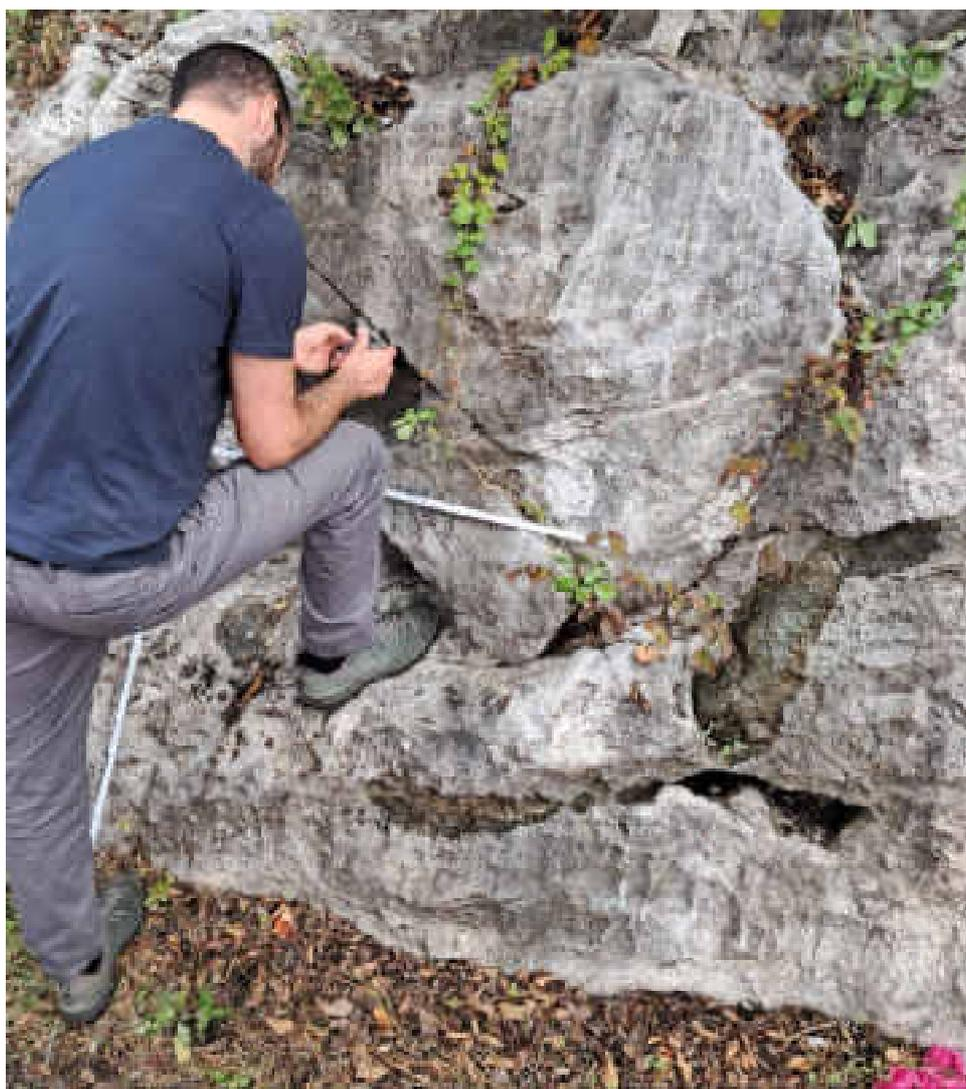
Foto n. 10 – Rilievo geomeccanico di dettaglio del fronte roccioso
